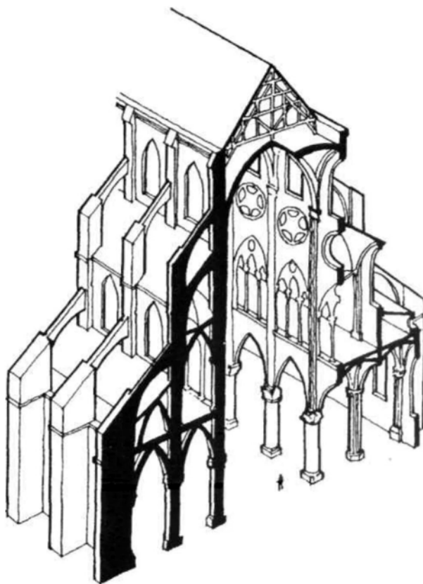
Рис. 4. Аксонометрический разрез собора Нотр-Дам в Париже. 1163-1345 гг.
